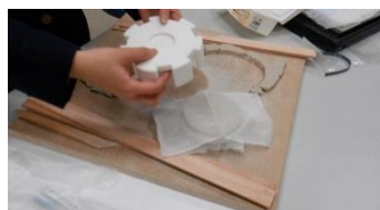
↑ ガーゼの上から上型 A と B を組み合わせ被せる
