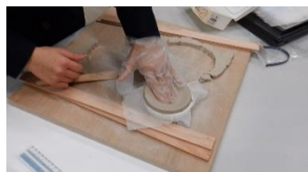
↑ 下型の上にガーゼを敷き その上に粘土を置く
