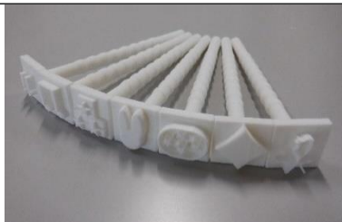
↑ 印刷後の個人の印。サポート材は除去 されている。
