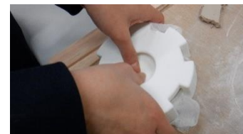
↑ 上型 A に手をかけ、B を 親指で押して A をはずす
